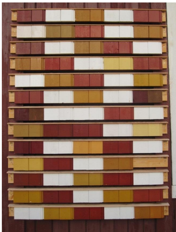
Figur 7. Nærbilde av malingprøvene. Foto. Brønne, august 2012. Figur 8. Malingprøvene til høyre for vinduet. De tre nederste prøvene er tjæreprøver som kun ble hengt opp på Røros. Under prøvene henger en informasjonsplakat om prosjektet. Foto: Brønne, august 2012.
