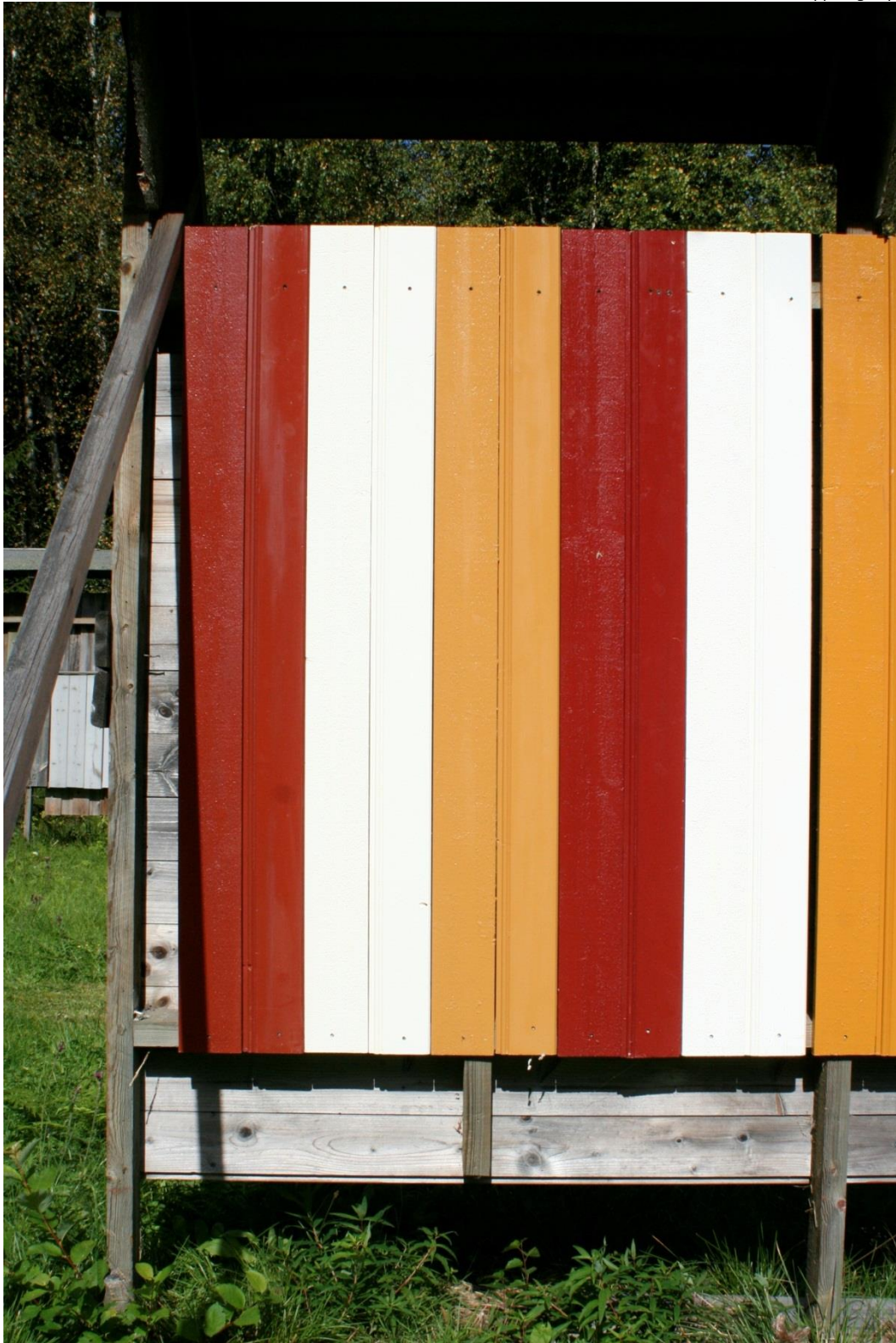
Figur 12. Bildet viser den første seksjonen av prøvene. 10 prøvepaneler er satt opp, deretter følger et lite mellomrom til de neste 10 prøvene. De rustfrie skruene som fester panelene til stenderne, er synlige. Foto: Brønne 31.8.2012.
