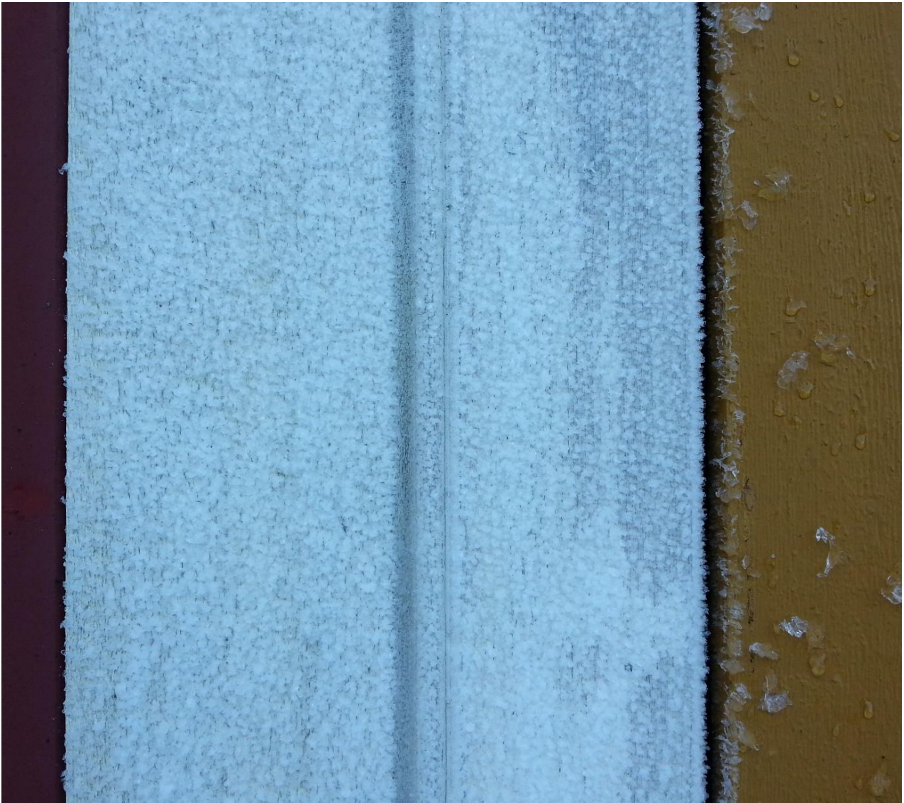
Figur 14. Linoljeprosjektet. Sørkedalen. Befaring 23.1.2017. Klokken 13.55 – 14.05. Detaljer av hvite prøver dekket av et krystallisert islag. Foto: Jon Brønne.
