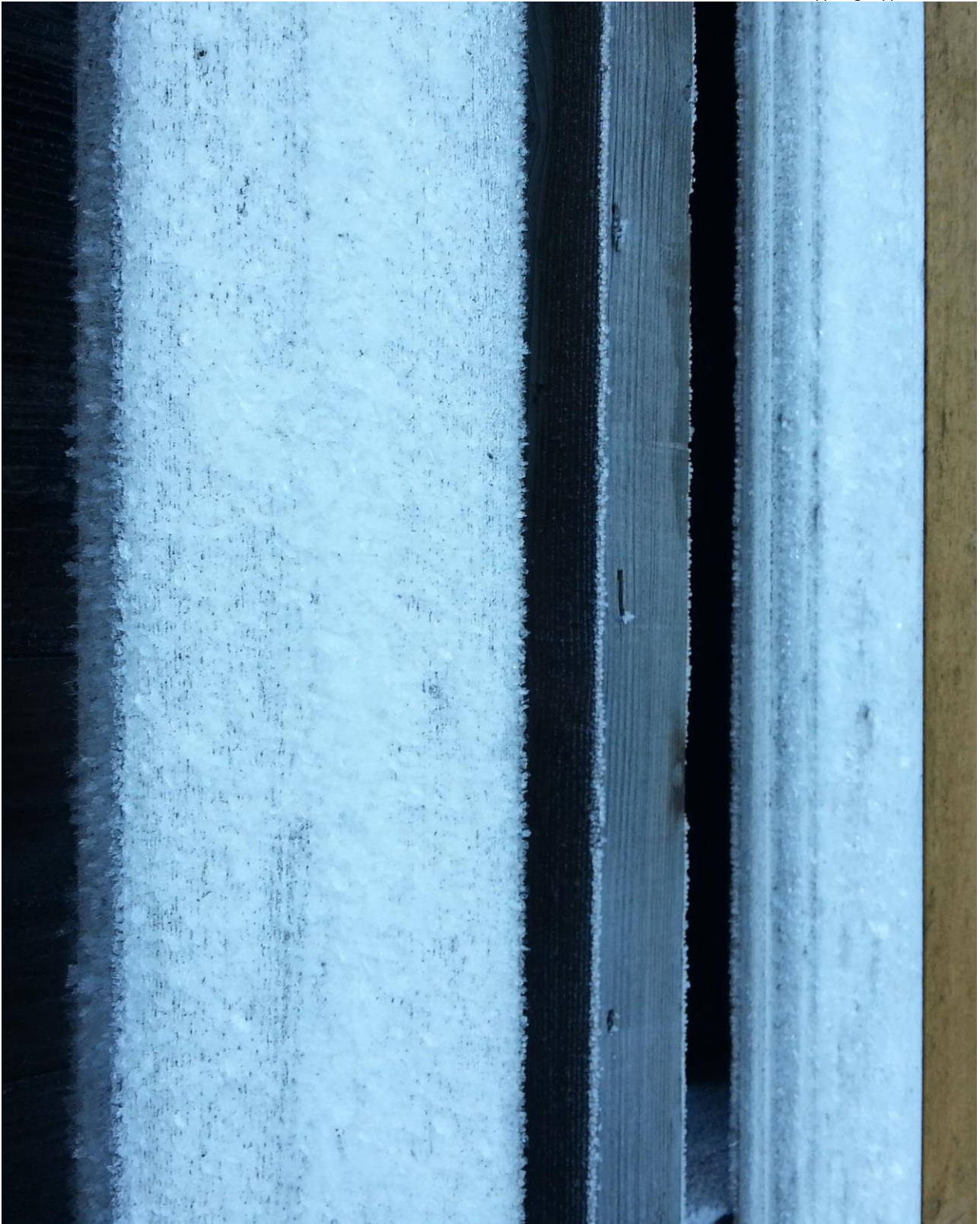
Figur 15. Linoljeprosjektet. Sørkedalen. Befaring 23.1.2017. Klokken 13.55 – 14.05. Detaljer av hvite prøver dekket av et krystallisert islag. Foto: Jon Brønne.
