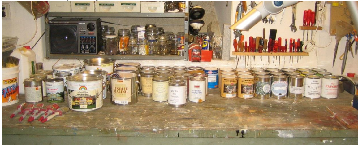
Figur 1. Et utvalg av de fabrikkproduserte linoljemalingene som er med i prøveserien. Foto: Brønne, januar 2011.
