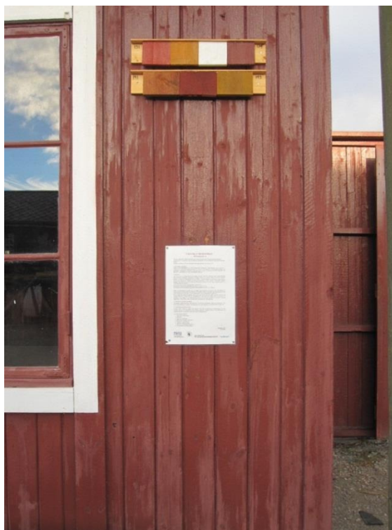
Figur 7. Nærbilde av malingprøvene. Foto. Brønne, august 2012. Figur 8. Malingprøvene til høyre for vinduet. De tre nederste prøvene er tjæreprøver som kun ble hengt opp på Røros. Under prøvene henger en informasjonsplakat om prosjektet. Foto: Brønne, august 2012.
