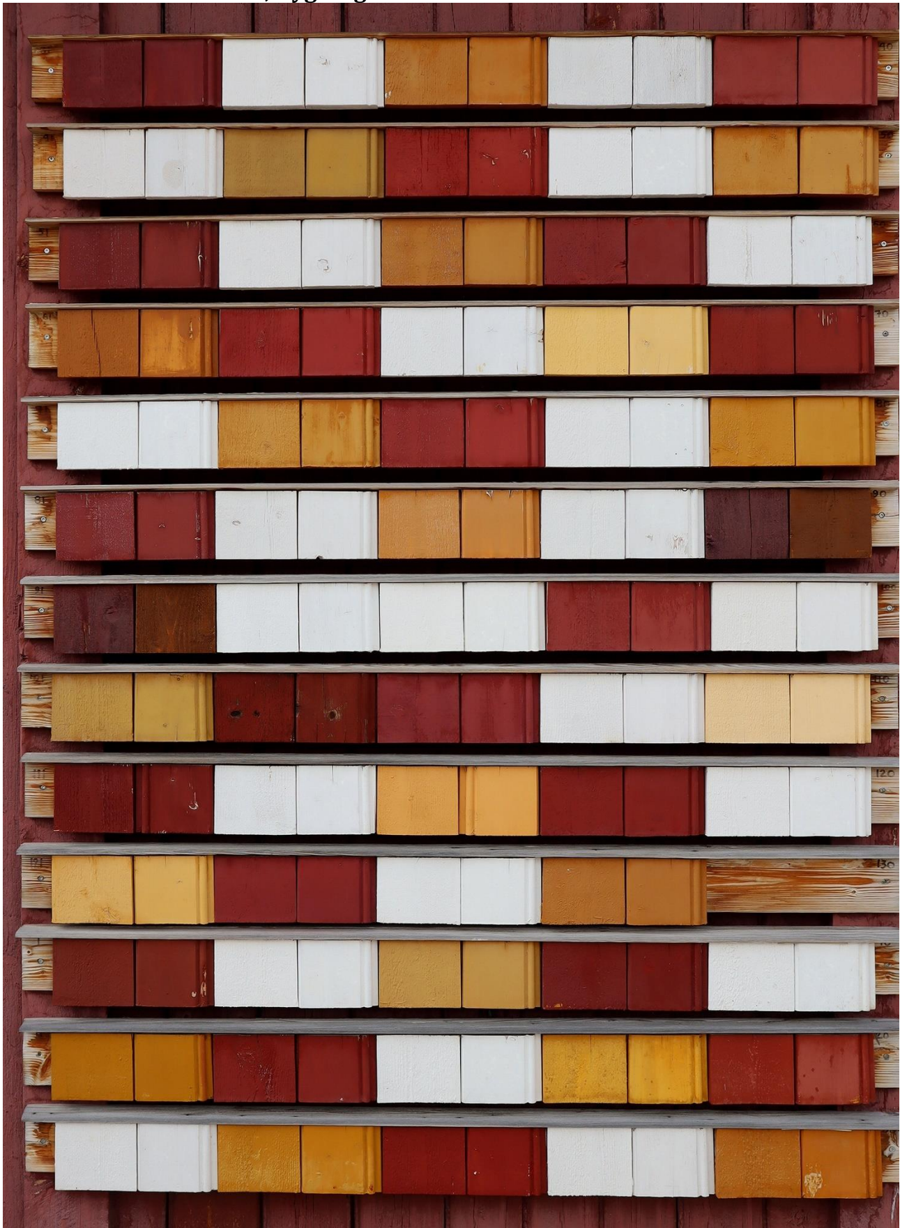
Figur 19. Prøvepanelet med prøvene på Raugarasjen, Rørosmuseet. Foto: Rørosmuseet, Bygningsvernsenteret.
