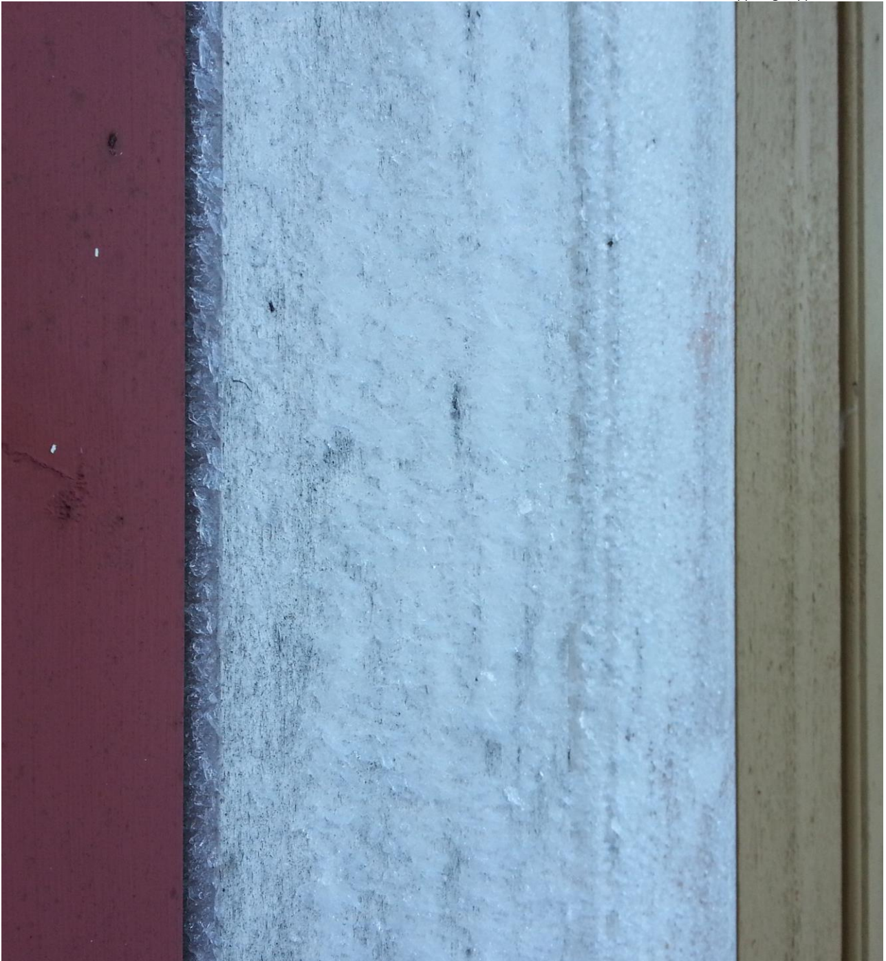
Figur 18. Linoljeprojektet. Sørkedalen. Befaring 23.1.2017. Klokken 13.55 – 14.05. Detaljer av hvite prøver dekket av et krystallisert islag. Foto: Jon Brønne.
